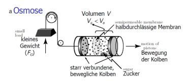
Der gerichtete Fluß von molekularen Teilchen (in der Regel Wasser) durch eine semipermeable Membran nennt man Osmose. Sie wird initiiert durch einen gelösten Stoff,(z.B. Zucker), der sich auf der einen Seite der Membran befindet und diese nicht passieren kann. Triebkraft der Osmose ist die Tendenz des Wassers die Zuckerlösung zu verdünnen und damit die Entropie zu erhöhen.
