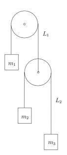
Die doppelte Atwood'sche Fallmaschine besteht aus zwei aneinander gehängten Fallmaschinen.
